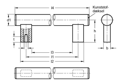
b = 18 t min = 15 d1 = 30 d2 = M8 h = 60 l1 = 250 l2 = 280 l3 = 220 l4 = 315
